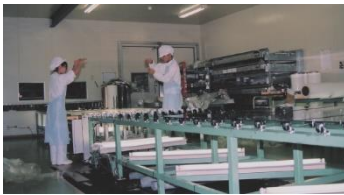
ガラス積層作業
